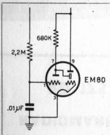
In caso di sostituzione dell'indicatore di sintonia, occorre usare una valvola uguale a quella già montata sull'apparecchio.
