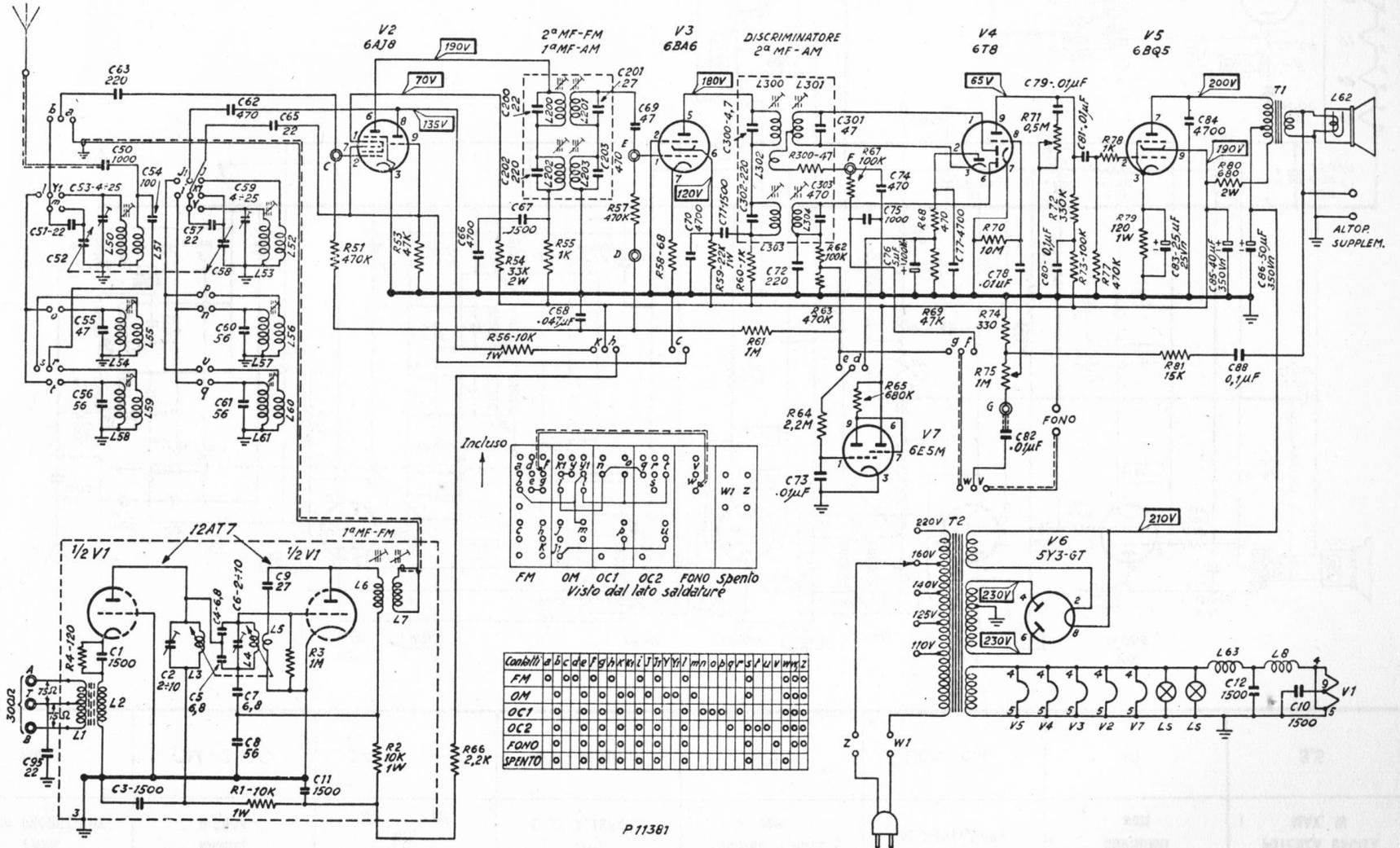
N. B.: Salvo notazioni in contrario le capacità si intendono in pF., le resistenze in ohm da 0,5 W, le tensioni alle valvole lette verso massa con voltmetro 20.000 ohm/V.
